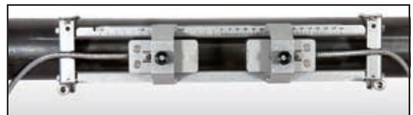
使用手持式Variofix VP安装探头
