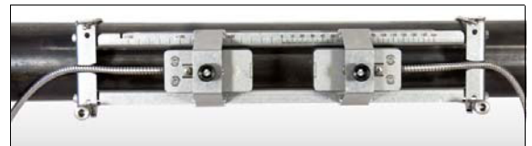
使用手持式Variofix VP安装探头
